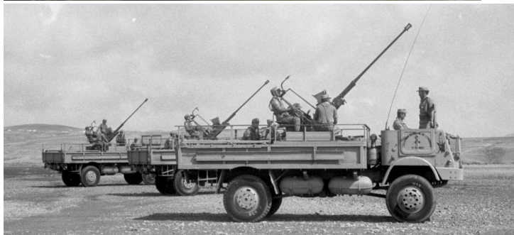
Los 3045 iniciales, de neumáticos traseros en montaje trasero sencillo, en el Sahara, con cañones antiáereos de 20/120
